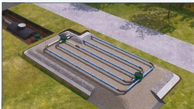
Figure 11 - principe d'un tertre d'infiltration (Source : innoclaire.fr )
