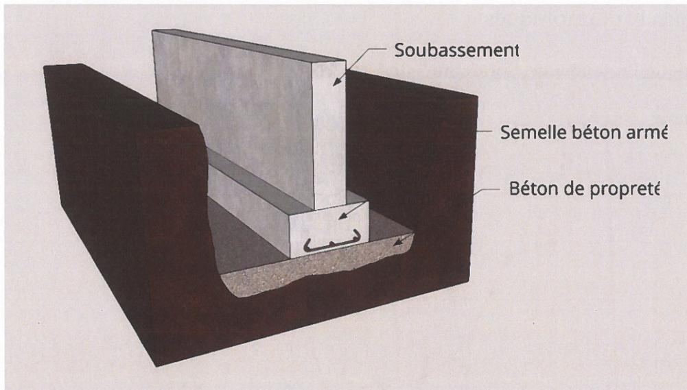
Il est important que la fondation se situe à une profondeur hors gel qui assure que le sol sous la fondation ne subira pas d'attaques causées par des cycles de gel-dégel. En Belgique, on considère une profondeur hors gel de 80 cm.
